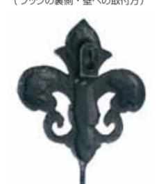
(取付金具)と表記のある商品は、写真のような穴の開いた鉄板が本体に溶接してあります。壁にねじを少し出した状態で打ち、穴にねじを引っかけて固定します。
